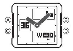
На рисунке изображен общий вид часов в Режиме Текущего Времени. Последовательное нажатие кнопки "С" обеспечивает переход из разряда в разряд в следующей последовательности: Режим Текущего Времени — Режим Мирового Времени — Режим Звукового Сигнала — Режим Секундомера — Режим Таймера Обратного Отсчета— Режим Текущего Времени.
