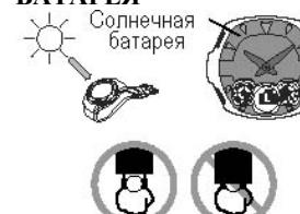
Данная модель часов снабжена элементом питания от солнца и аккумуляторной батареей, которая заряжается электрической энергией, преобразованной из солнечной энергии.
