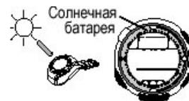
Данная модель часов снабжена элементом питания от солнца и аккумуляторной батареей, которая заряжается электроэнергией, преобразованной из солнечной энергии.
