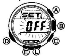
1. В режиме Высотомера нажмите и удержите кнопку «E» до тех пор, в верхней части экрана не появится индикатор SET.
