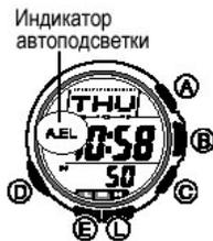
В Ваших часах используется электролюминесцентная подсветка, позволяющая считывать показания табло даже в полной темноте. Функция автоподсветки автоматически подсвечивает экран, когда Вы поворачиваете часы к себе.
