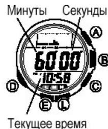
Обратный отсчет времени может быть задан в диапазоне от 1 минуты до 60 минут. Как только счетчик обратного отсчета достигнет нуля, подается звуковой сигнал.
