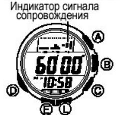
Нажмите кнопку «A» в тот момент, когда на экране находится стартовое значение обратного отсчета времени или в процессе самого отсчета для того, чтобы включить (индикатор на экране) или выключить (нет индикатора) сопровождающий сигнал обратного отсчета времени.
