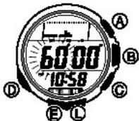
1. В режиме Таймера нажмите и удержите кнопку «E», до тех пор, пока не начнет мигать цифровое значение стартового времени, обозначая переход к режиму установки.
