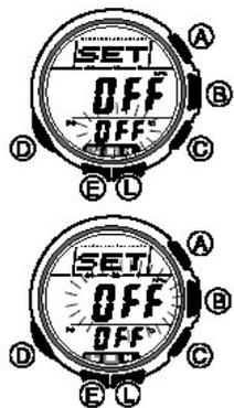
1. Для того чтобы перевести часы в режим Барометра / Термометра, используйте кнопку «В».
