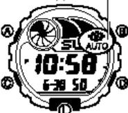
В Ваших часах используется электролюминесцентная подсветка, позволяющая считывать показания табло даже в полной темноте. Функция автоподсветки включает подсветку экрана, когда Вы поворачиваете часы к себе.
