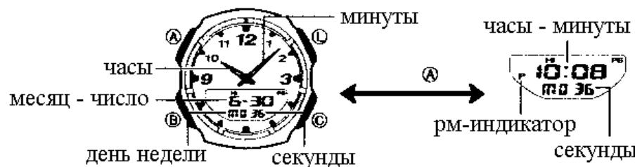
На рисунке изображен общий вид часов в Режиме Текущего Времени. Нажмите кнопку “B” для перехода из разряда в разряд в следующей последовательности:
