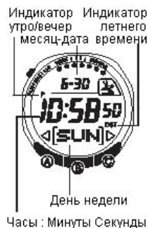
Индикатор утро/вечер, Индикатор летнего времени, Индикатор месяц-дата, День недели, Часы : Минуты Секунды
