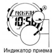
7. Нажмите и удержите кнопку «A» в течение 2 секунд, до тех пор, пока часы не исполнят звуковой сигнал.
