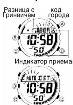
1. Нажмите кнопку «В» в Режиме Текущего времени. На экране мигает индикатор включения / выключения автоматического приема сигнала, обозначая переход к режиму установки.
