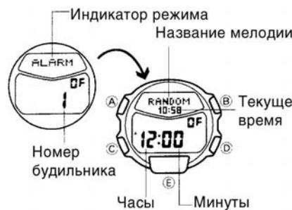
В вашем распоряжении пять будильников с различными мелодиями. Если включен Ежедневный будильник, звуковой сигнал продолжается 20 секунд в установленное время каждый день. Для остановки сигнала нажмите любую кнопку (за исключением «E»). Нажатие кнопки «E» во время исполнения мелодии переключает экран между фигурками анимационной графики и названием исполняемой мелодии. Если включен Ежечасный сигнал, он раздается в начале
