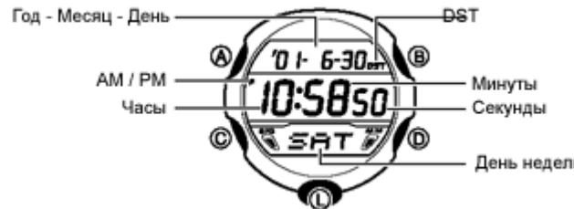
На рисунке изображен общий вид часов в режиме текущего времени. Нажмите кнопку "C" для перехода из режима в режим.
