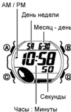
На рисунке изображен общий вид часов в Режиме Текущего Времени. Нажмите кнопку "C" для перехода из режима в режим в следующей последовательности: Режим Текущего Времени – Режим Записной Книжки – Режим Звукового Сигнала – Режим Секундомера – Режим Таймера Обратного Отсчета – Режим Двойного Времени – Режим Текущего Времени.
