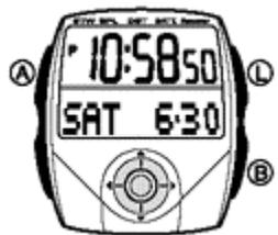
На рисунке изображен общий вид часов в режиме текущего времени. Нажмите кнопку • для перехода из режима в режим. Режим Текущего времени – Режим Записной Книжки – Режим Мирового Времени – Режим Секундомера – Режим Таймера Обратного Отсчета – Режим Звукового Сигнала – Режим Текущего времени.
