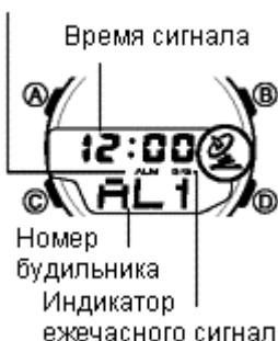
Вы можете установить три различных ежедневных звуковых сигналов .По достижении установленного времени звуковой сигнал включится на 10 секунд. Если включен режим индикации начала часа, короткий звуковой сигнал будет подаваться в начале каждого часа.
