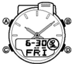
На рисунке изображен общий вид часов в режиме текущего времени. Нажмите кнопку “С” для перехода из режима в режим.
