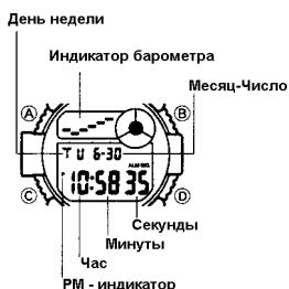
На рис.1., изображен общий вид часов в режиме Текущего времени.
