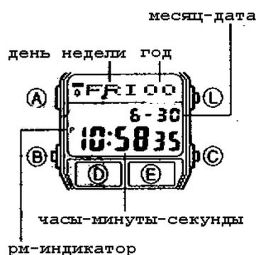
На рисунке изображен общий вид часов в режиме текущего времени. Нажмите кнопку “В” для перехода из режима в режим. Режим Текущего Времени – Режим Записной Книжки – Режим Звукового Сигнала – Режим Секундомера – Режим Текущего Времени. В любом режиме нажмите кнопку “L” для подсветки дисплея .
