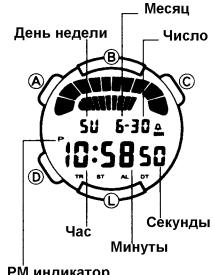
На рис.1., изображен общий вид часов в режиме Текущего времени. Кнопка D осуществляет переход между режимами часов. После осуществления необходимых действий в любом режиме, нажмите кнопку D для возврата в режим текущего времени. Переход между режимами осуществляется в следующей последовательности:
