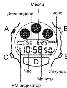
На рис.1., изображен общий вид часов в режиме Текущего времени. Кнопка С осуществляет переход между режимами часов. После осуществления необходимых действий в любом режиме, нажмите кнопку С для возврата в режим текущего времени. Переход между режимами осуществляется в следующей последовательности:
