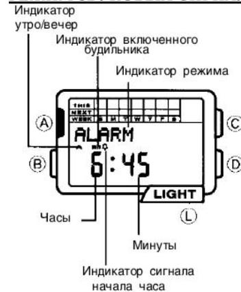
Если на часах подключена установка сигнала будильника, то звуковой сигнал будет раздаваться каждый день в заданное время в течение 20 секунд. Чтобы прервать исполнение сигнала, когда он начнет звучать, нажмите любую кнопку. Если на часах подключена установка сигнала начала часа, то звуковой сигнал будет раздаваться в начале каждого часа.
