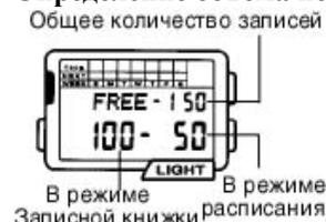
При работе в режиме записной книжки вы можете вывести на табло объем свободной и использованной в каждом режиме памяти путем нажатия и удерживания в нажатом состоянии кнопки =.
