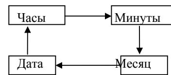
3. Нажмите кнопку “D” для увеличения выбранного значения. Удержание этой кнопки в нажатом состоянии позволяет изменять показания на высокой скорости.
