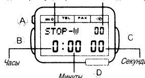
Режим секундомера позволяет измерять отдельные отрезки времени, разделенное время, а также фиксировать время первого и второго места. Общий измеряемый интервал времени ограничивается 23 часами 59 минутами 59,99 секундами. Измерение времени производится с точностью до одной сотой секунды.
