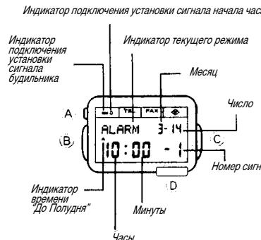
Вы можете задать 5 независимых друг от друга звуковых сигналов с указанием часа, минут, месяца и числа. Если на часах подключена установка сигнала будильника, то звучание сигналов будет раздаваться в заданное время в течение 20 секунд. Для прерывания звучания сигнала, нажмите одну из кнопок "A", "C" или "D". Если на часах подключена установка сигнала начала часа, то звучание сигнала будет раздаваться в начале каждого часа.
