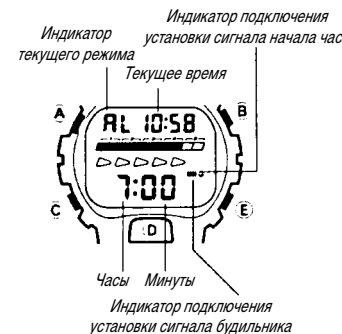
Если на часах подключена установка сигнала будильника, то звучание сигнала будет раздаваться каждый день в заданное время в течение 20 секунд. Нажмите любую кнопку, чтобы прервать исполнение сигнала, когда он начнет звучать.
