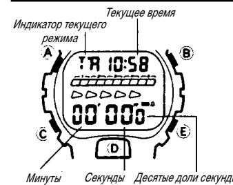
Обратный отсчет времени может быть задан в пределах от 1 секунды до 60 минут. Как только таймер достигнет нуля, раздается звучание сигнала, которое будет продолжаться 10 секунд, если не будет нажата ни одна из кнопок.
