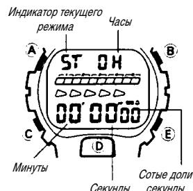
Режим секундомера позволяет измерять полное и промежуточное время событий, а также фиксировать два первых результата в соревнованиях. Кроме того имеются функция авто-старта и функция заданного времени. Максимальный диапазон измеряемого секундомером времени составляет 23 часа 59 минут 59,99 секунд.
